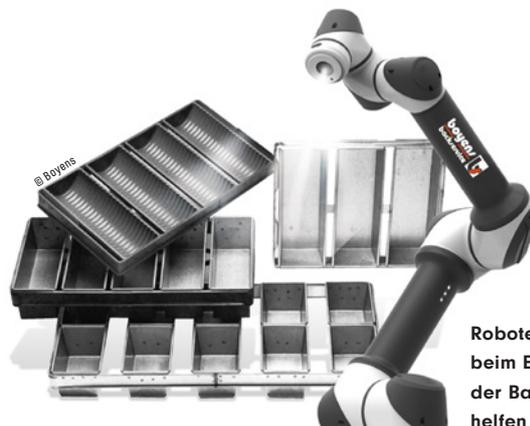
Roboter-Arme, die beim Einsprühen der Backformen helfen
