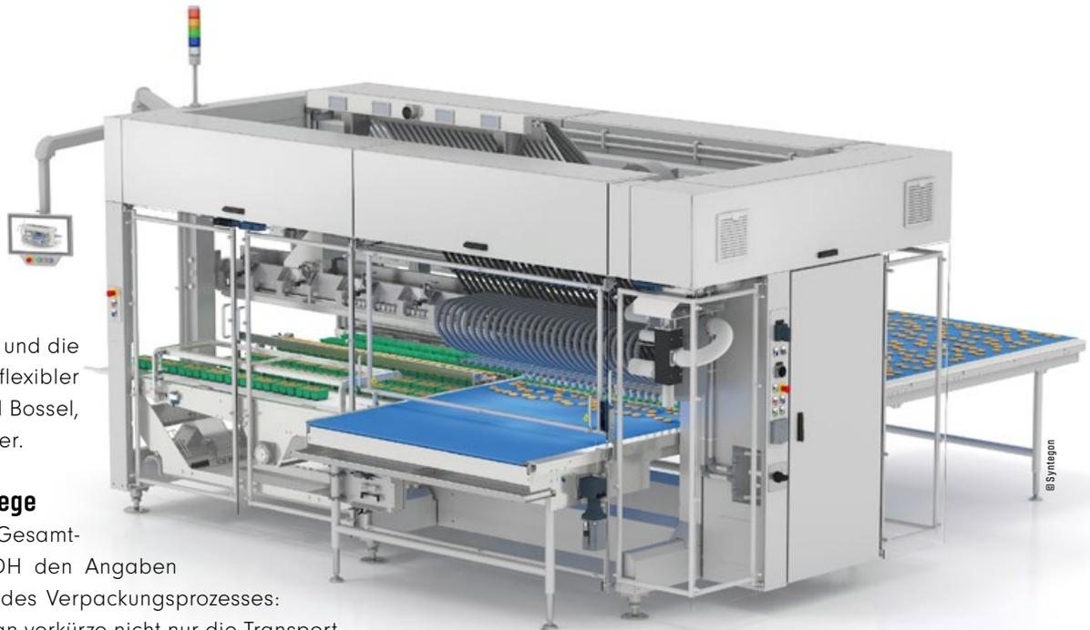
Die „Syntegon IDH“ mit neu entwickelter Pickertechnologie auf Basis von Linearmotoren: Durch ihre gleichmäßigen Bewegungen wird ein schonendes Handling der Produkte möglich
