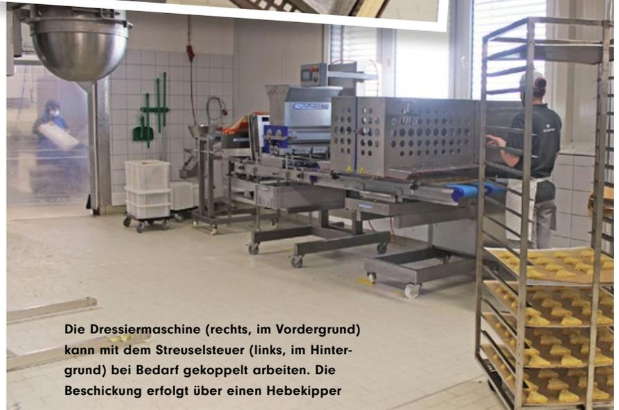
Die Dressiermaschine (rechts, im Vordergrund) kann mit dem Streuselsteuer (links, im Hintergrund) bei Bedarf gekoppelt arbeiten. Die Beschickung erfolgt über einen Hebekipper
