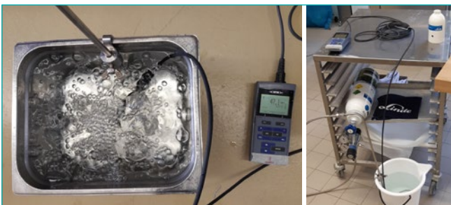
Abb. 5: Manuelle O 2 -Imprägnierung des Schüttwassers mit Linde Equipment. Versuchsdurchführung der Linde GmbH bei Einsatz im Backbetrieb
